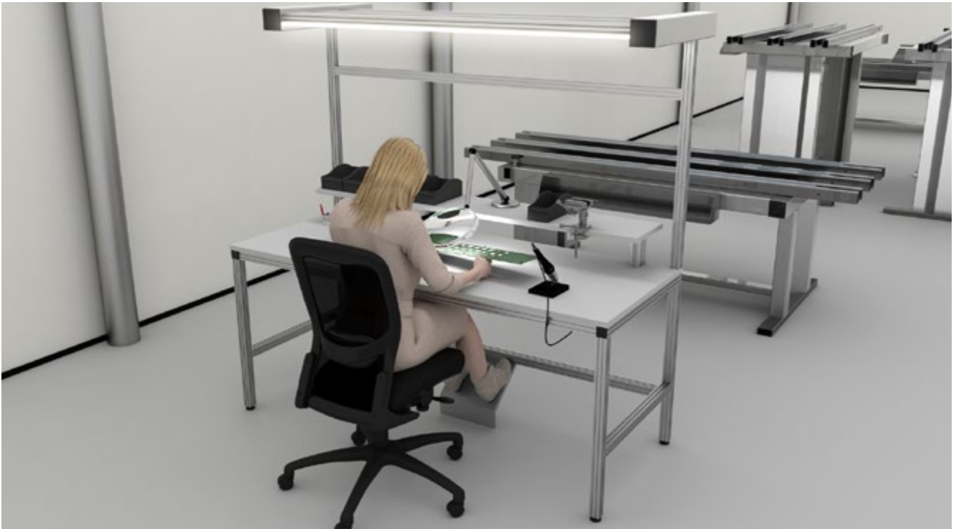
Abb. 15 Beispiel für eine auf den Bereich des Arbeitsplatzes bezogene Beleuchtung (500 lx) mit einer teilflächenbezogenen Beleuchtung (Lupenleuchte) (zum Beispiel 1000 lx)
