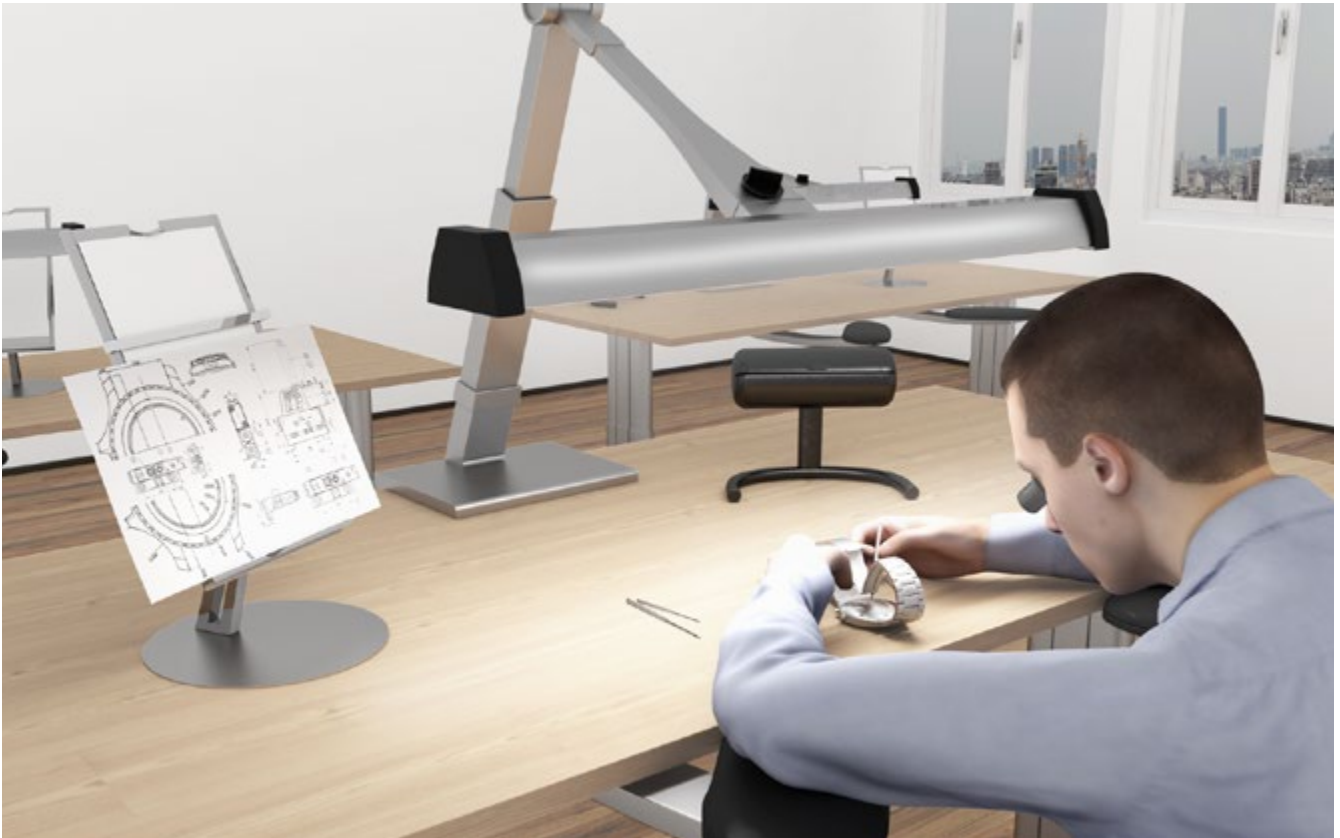
Abb. 17 A: Teilflächenbezogene Beleuchtung an einem Uhrmacherarbeitsplatz
